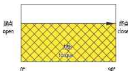
双作用执行器力矩输出图 Output Torque of Double Acting Actuator
