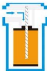
弯角进气口和滤芯顶部卡口设计 直角进气口和滤芯带拉杆式设计
