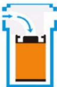
弯角进气口和滤芯顶部卡口设计 直角进气口和滤芯带拉杆式设计
